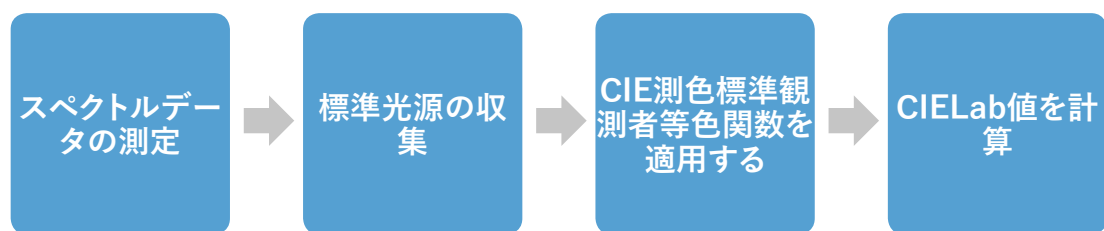
図5 CIELAB標準に従って、サンプルから反射された光の収集から、FoodScan 2スクリーン上に提示されたL * a * b値までのステップ。
